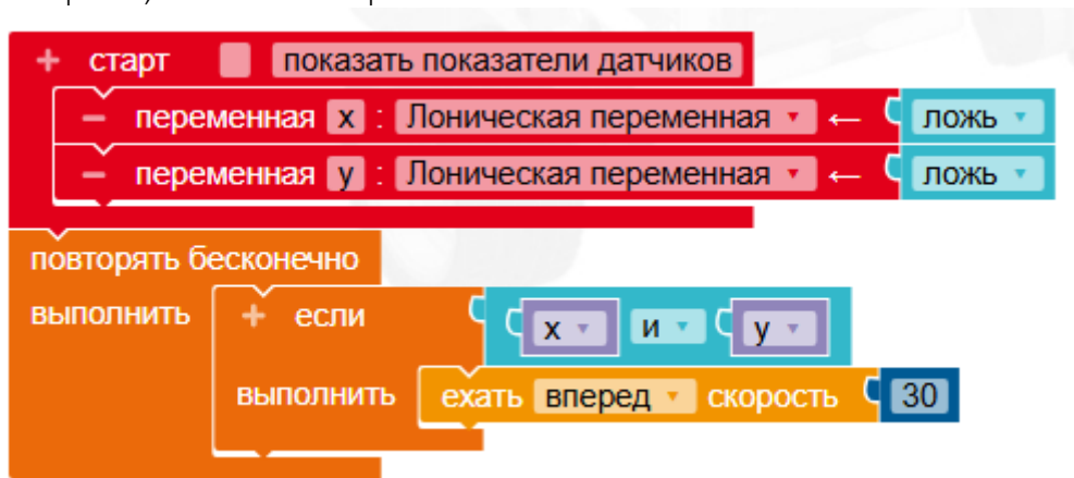
Рисунок 3. Пример программы «Базовая логическая операция «Конъюнкция»
