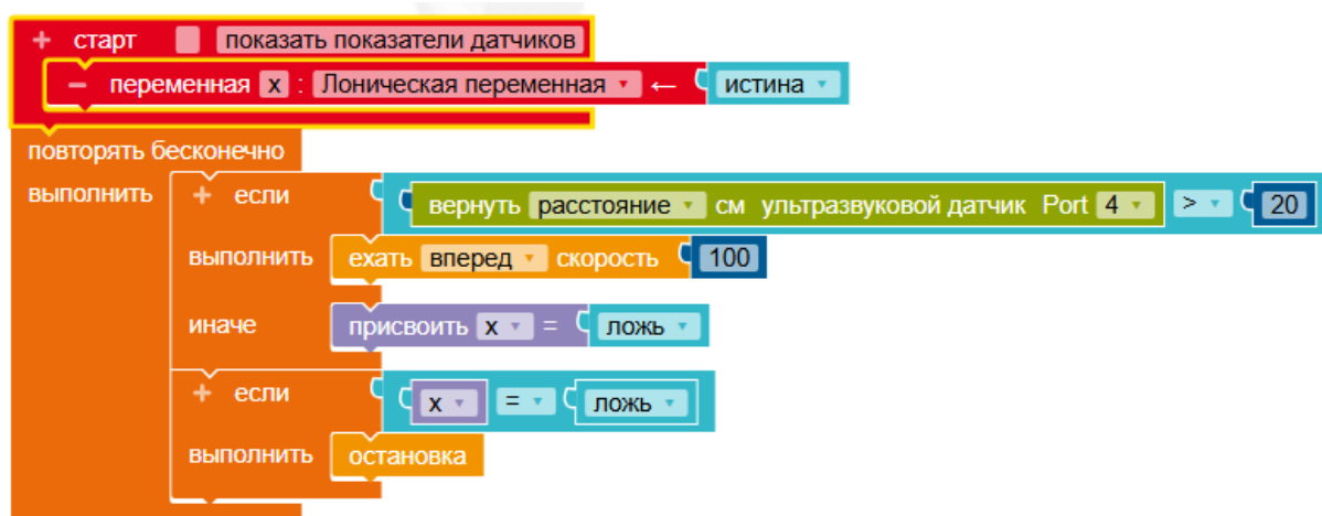
Рисунок 6. Пример программы «Логические операции с датчиком»
