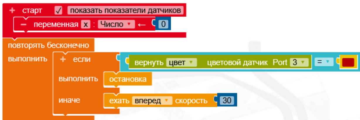
Рисунок 3. Пример программы «Светофор»
