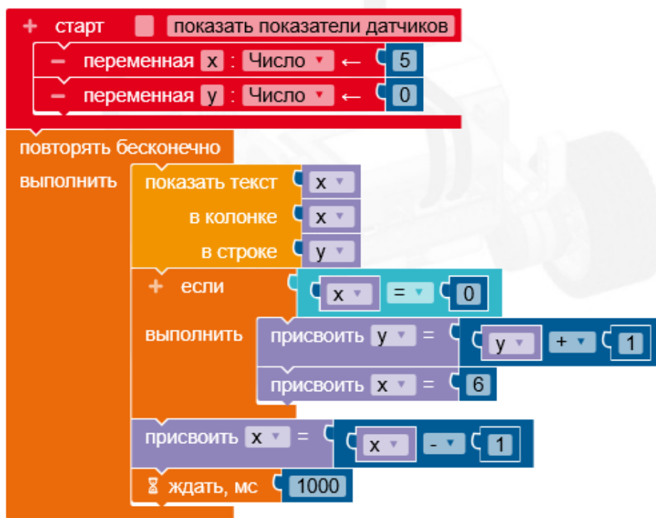
Рисунок 6. Пример программы «Вывод последовательности чисел на экран»
